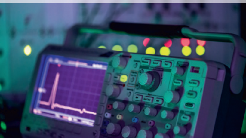
Oszilloskop mit dem elektronischen Signal eines ultrakurzen Laserpulses. Im Hintergrund die Indikatorleuchtdioden des räumlichen Strahlstabilisierungssystems.
