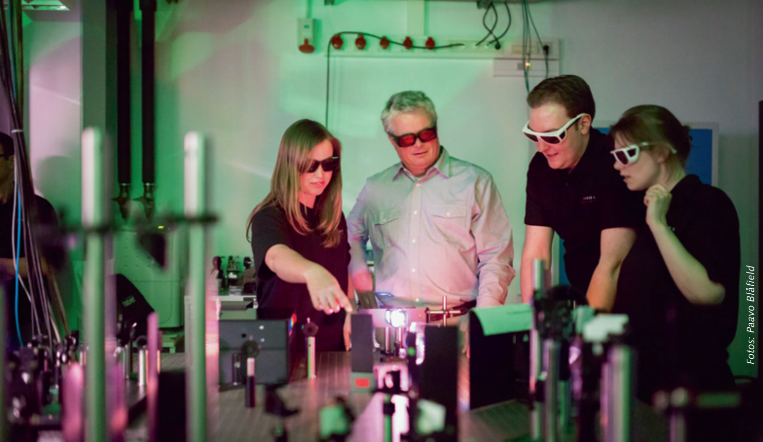
Prof. Dr. Thomas Baumert und Mitarbeiter im Laserlabor. Im Vordergrund das weiße Licht der verstärkten ultrakurzen Laserpulse; im Hintergrund das grüne Licht des Pumpasers, der die Energie zur Verstärkung dieser ultrakurzen Pulse erbringt.
